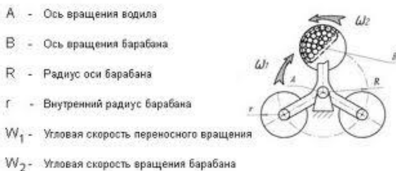
Рисунок 1 – схема центробежно-планетарной мельницы
